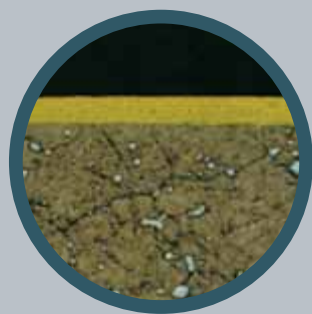
INGRANDIMENTO AL MICROSCOPIO DEL RIVESTIMENTO YELLOW TIGER SP. 3 MICRON
